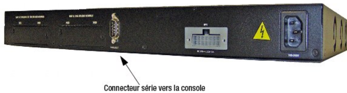
Figure 4-5. Connexion série vers le commutateur
