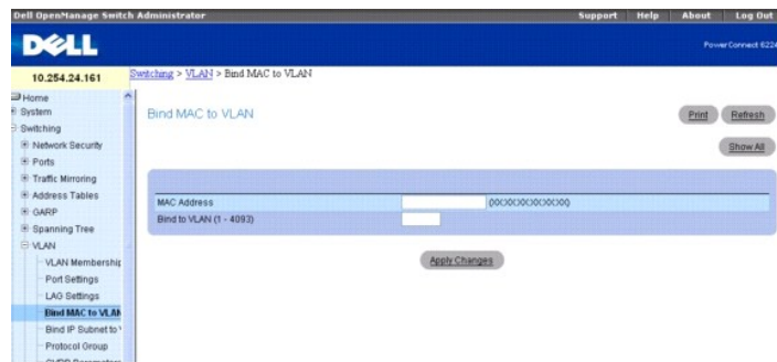
Figure 8-55. Page Bind MAC to VLAN (Lier des adresses MAC et des VLAN)
