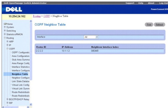
Figure 10-12. OSPF Neighbor Table (Table des routeurs OSPF voisins)
